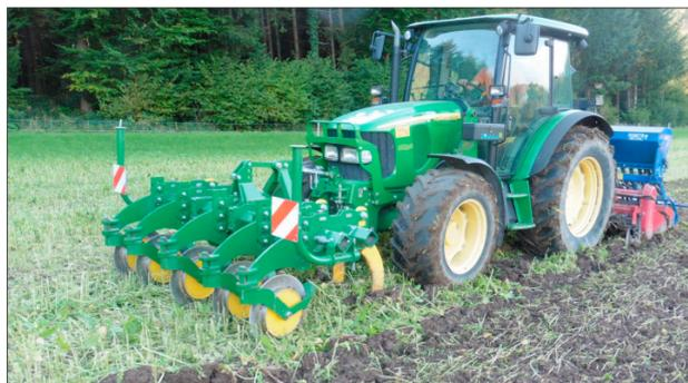
Mulchsaat nach «Löwenzahn» (Daniel Böhler hat dieses Gerät mitentwickelt, greift 25-30 cm tief) und Rototiller.
