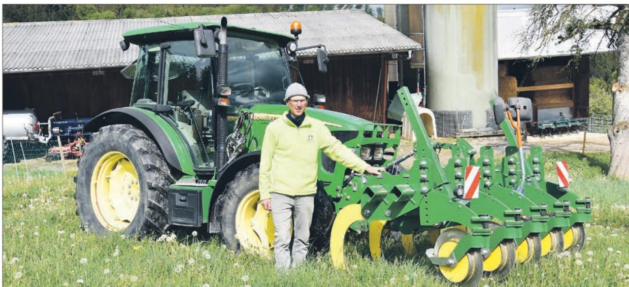
Der Löwenzahn ist ein Bodenlockerungsgerät im Frontanbau. Vor jeder Zinke läuft ein verstellbares Schneidstützrad. Meist wird die Bodenbearbeitungsmaschine hinten mit einer Sämaschine kombiniert. Das Gewicht verteilt sich gleichmässig auf den Boden. (Bilder jba)
