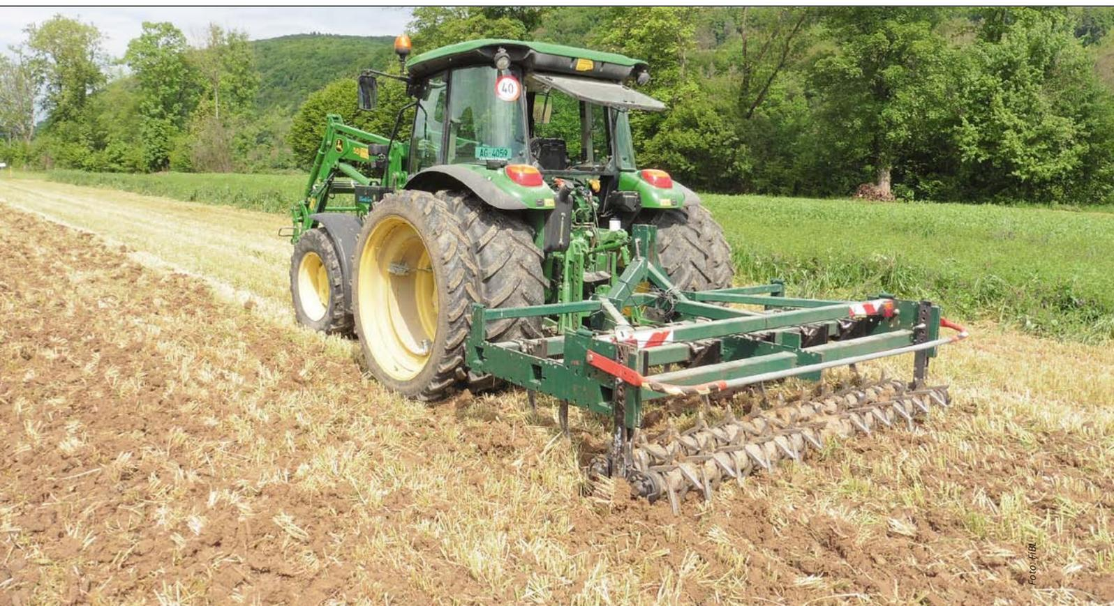
Flachgrubber (im Bild:Weco-Dyn) ermöglichen einen flachen Umbruch, verbunden mit hohen Flächenleistungen.
